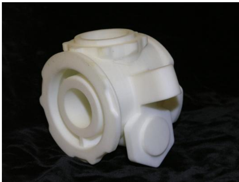
Рисунок 2. Модель отливки "Корпус насоса" из ABS-пластика.
