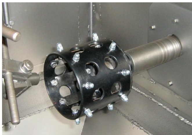
Рисунок 5. Имитатор с настроечными образцами в камере струйно-динамической установки
