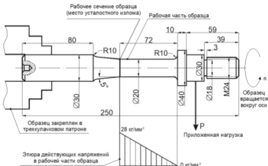
Рисунок 1. Схема нагружения испытываемого вала
