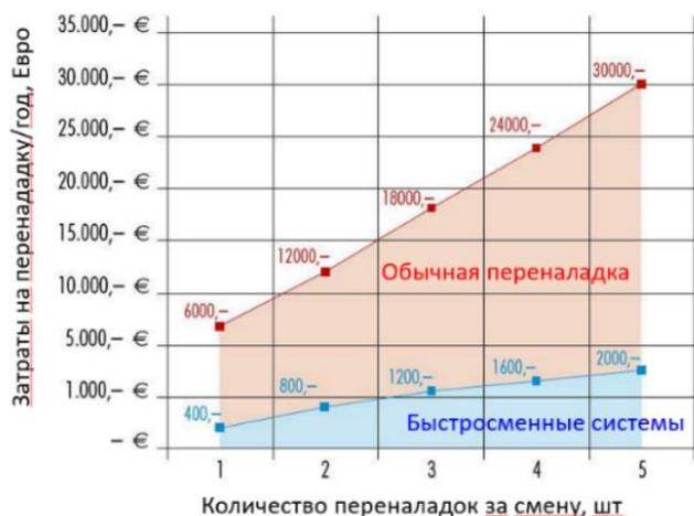
Рисунок 8. Сравнение затрат при традиционной переналадке и с применением быстросменных систем нулевого базирования
