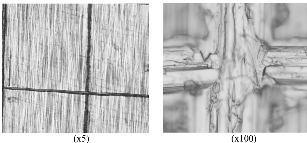
Рисунок 3. Состояние поверхности покрытия с полиизобутиленом (время выдержки жидкого состава 24 часа)
