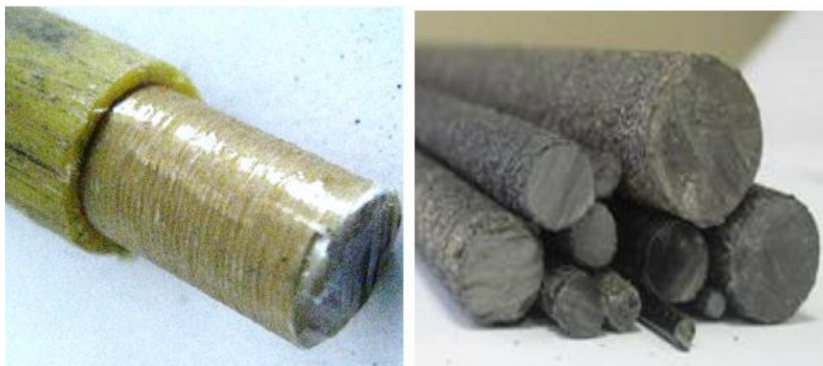
Рисунок 1 – Вид реза стержня из стеклонити и угленити
