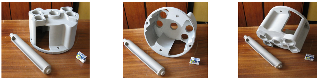
Рисунок 6 - Керамикоподобное покрытие на поверхности алюминиевых комплектующих расхождомера
