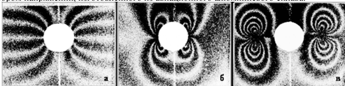
Рис. 4. Спекл-интерферограммы осевой компоненты перемещений, зарегистрированные при испытаниях на растяжение плоского образца с круговым концентратором напряжений: а – упругое деформирование; б – остаточное деформирование; в – развитие усталостных трещин.
