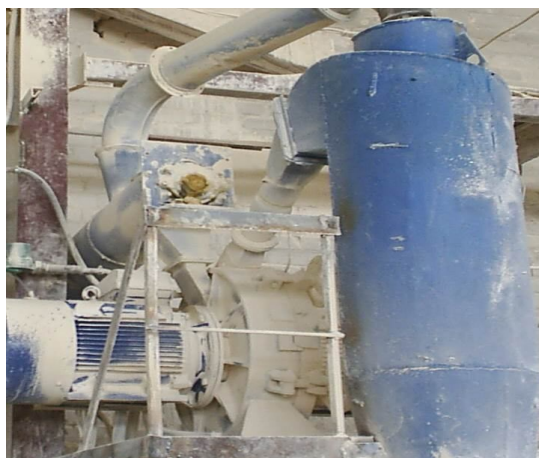
Рис. 3. Общий вид дезинтегратора сверхтонкого измельчения DESI-14
