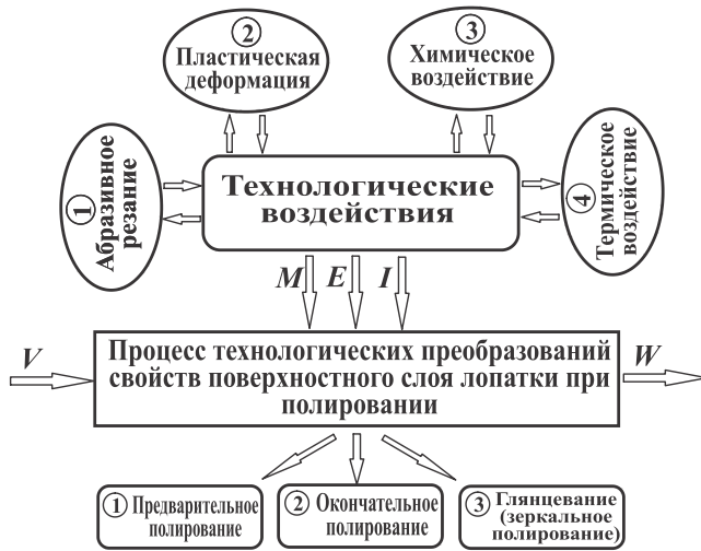
Рис. 1. Системная модель процесса технологических преобразований свойств поверхностного слоя лопатки при полировании
