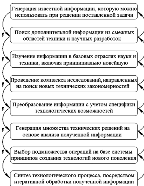
Рис. 2. Укрупненный алгоритм итеративной стратегии ФОМ разработки новых технологических процессов в машиностроении
