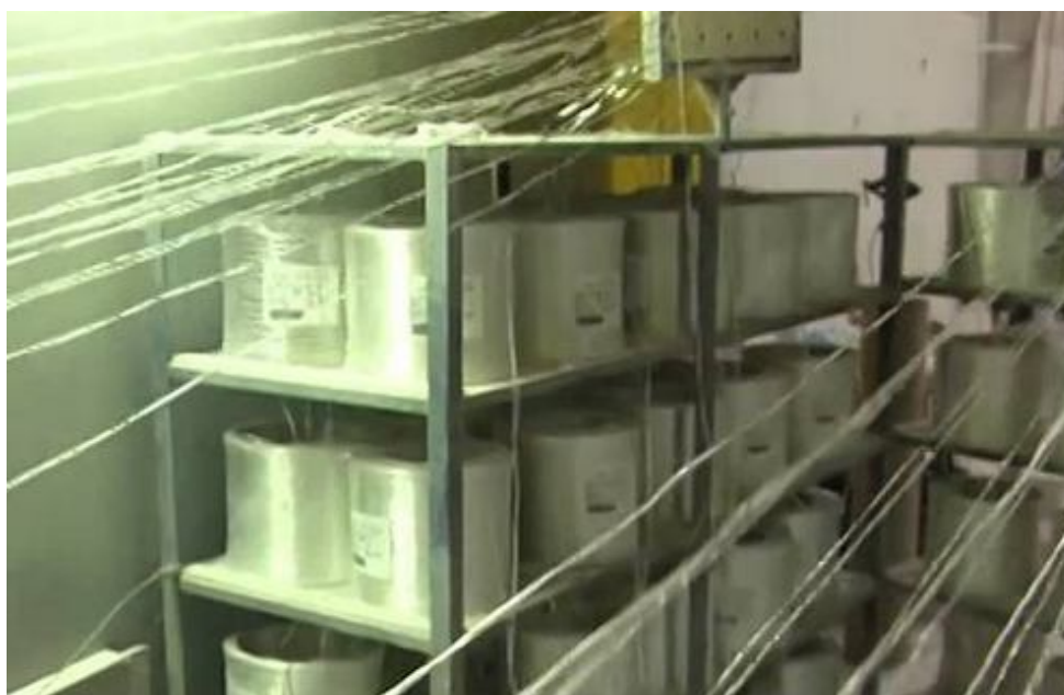
Рис. 2 Шпулярник полочного типа с системой предварительного натяжения продольной арматуры
