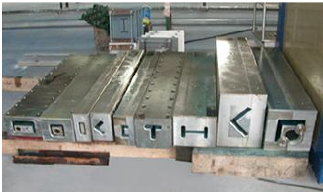
Рис. 4 Фильеры для формования изделий различных поперечных сечений
