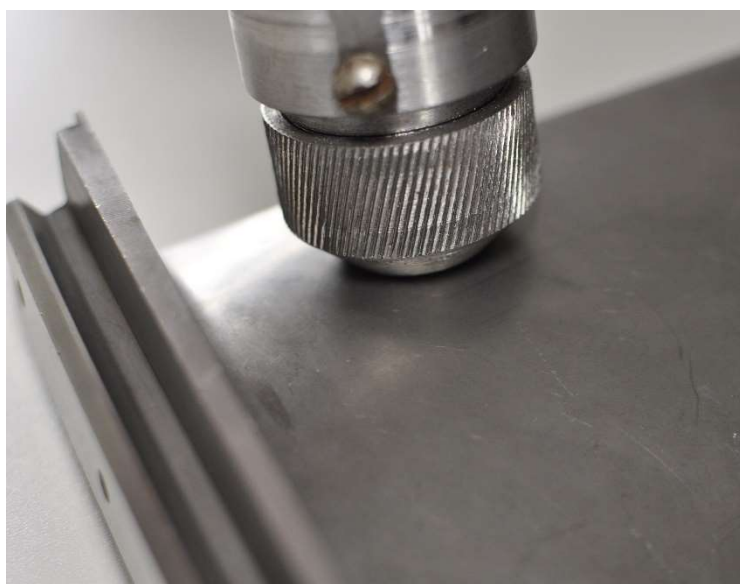
Рисунок 5. Зона контакта устройства ППУ и контрольного образца
