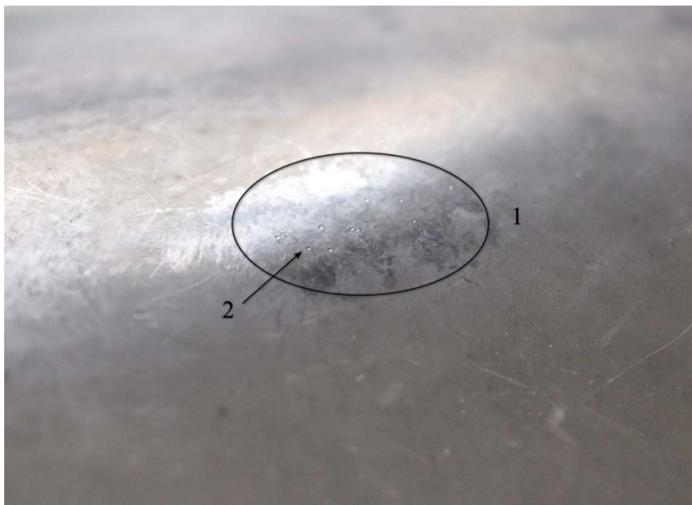
Рисунок 6. Упрочненная зона на контрольной заготовке: 1 – упрочненная зона; 2 – следы от измерений портативным твердомером.
