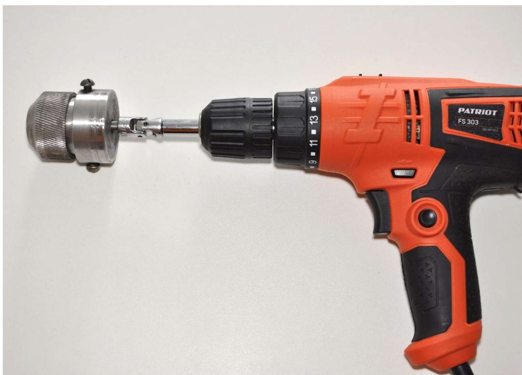
Рисунок 2. Общий вид экспериментальной портативной установки для поверхностно-пластического упрочнения
