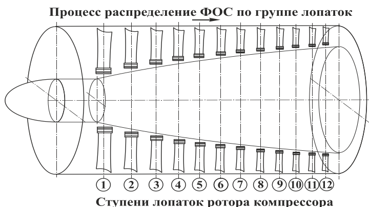
Рисунок 4. Схема процесса распределения ФОС по группе рабочих лопаток ротора компрессора ГТД
