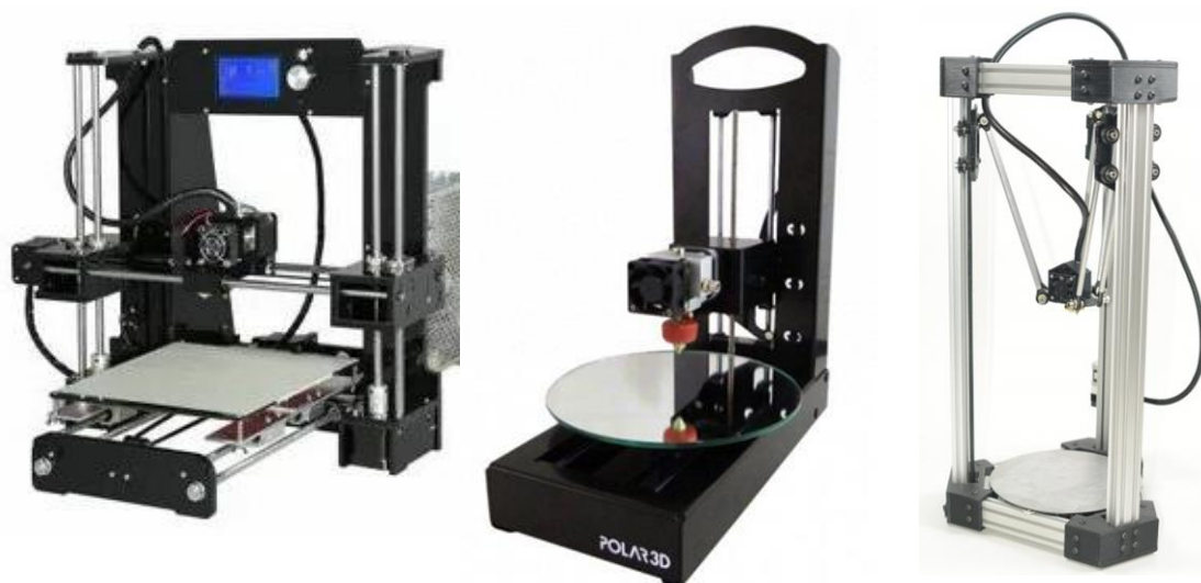
Рисунок 1. Вид 3D-принтеров, реализующих работу в декартовой, полярной системах координат и на основе параллельных структур, соответственно
