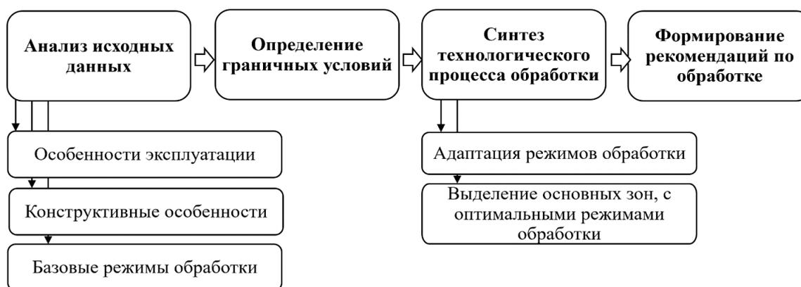
Рисунок 5. Блок-схема процесса адаптации процесса при обработке сложного криволинейного профиля ЛТ ГТД
