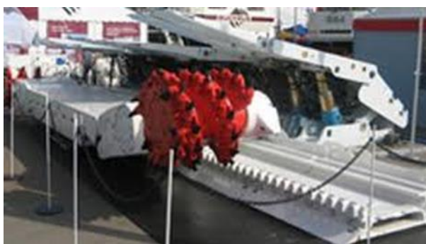
Рисунок 1. Вид очистных комбайнов со шнековым и барабанным исполнительными органами.
