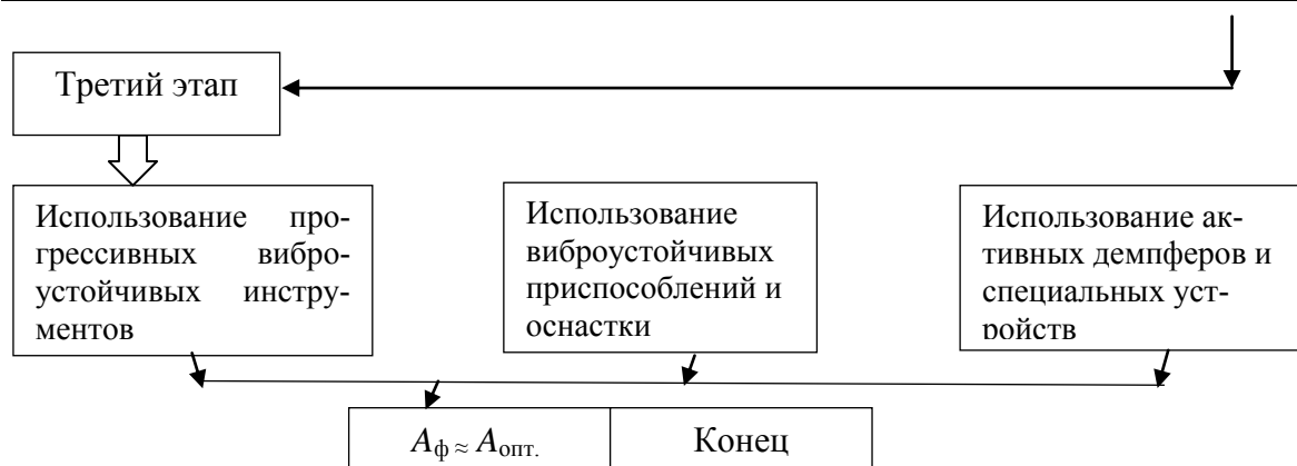
Рисунок 6. Блок-схема методики нахождения режимов оптимального резания и управления интенсивностью автоколебаний процесса точения на станках с ЧПУ.
