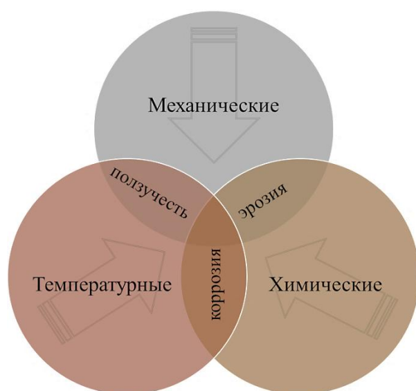
Рисунок 5. Структура комплексных воздействий на ЛТ ГТД
