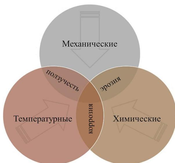
Рисунок 5. Структура комплексных воздействий на ЛТ ГТД
