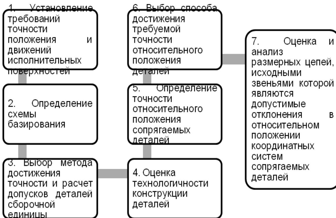
Рисунок 1. Последовательность действий при размерном анализе.
