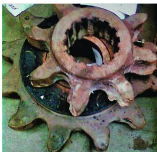
Рисунок 4. Вид изношенных приводных зубчатых колёс БСП Eicotrack
