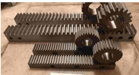
Рисунок 1. Вид колёсно-реечного движителя
