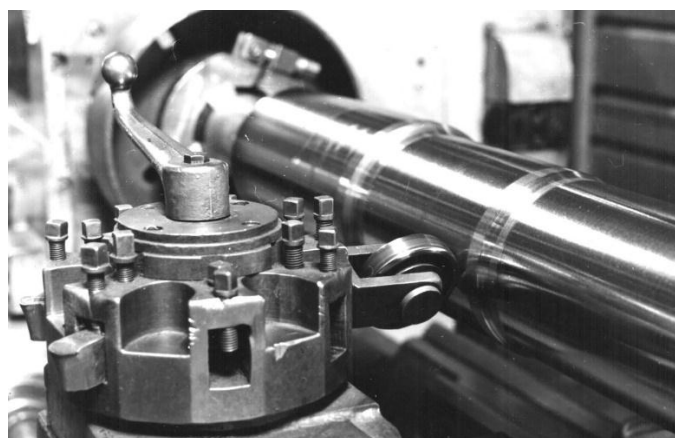
Рисунок 3. Накатка оси локомотива при помощи существующего (а) и предложенного (б) инструмента
