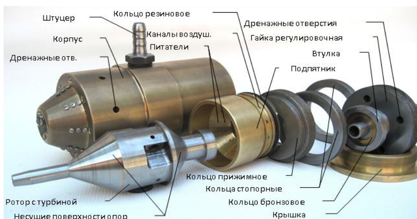
Рисунок 5. Экспериментальный образец высокоскоростного пневмошпинделя.
