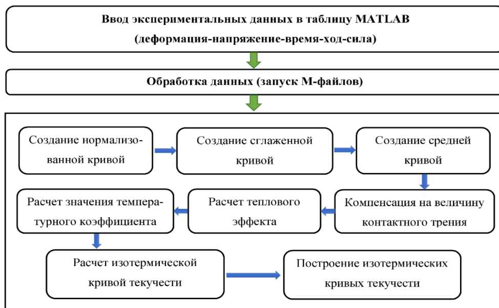
Рисунок 2. Схема построения «изотермической» кривой текучести сплава АМг6
