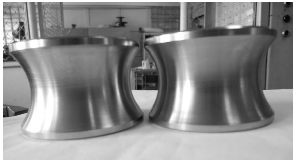
Рисунок 2. Фасонные поверхности деталей металлургического оборудования
