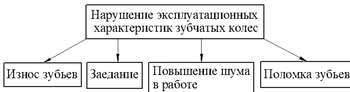
Рисунок 1. Виды нарушения эксплуатационных характеристик зубчатых колес
