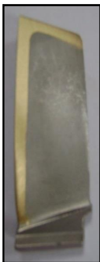
Рисунок 8. Лопатка компрессора с 1-м слоем ФОП
