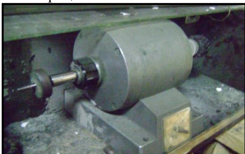
Рисунок 12. Общий вид установки для полировки лопаток компрессора
