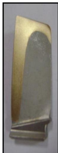
Рисунок 9. Лопатка компрессора со 2-м слоем ФОП
