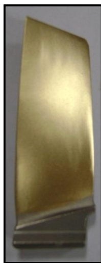
Рисунок 11. Лопатка компрессора с 4-м слоем ФОП
