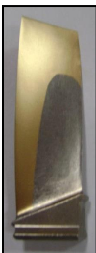
Рисунок 10. Лопатка компрессора с 3-м слоем ФОП
