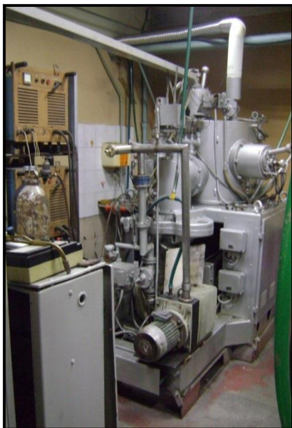
Рисунок 5. Общий вид вакуумной установки ННВ 6,6 – И1 для напыления ФОП лопаток компрессора
