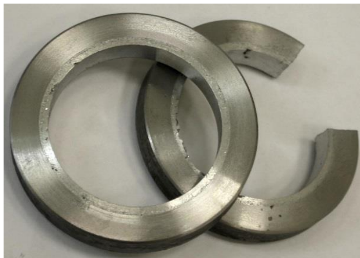
Рисунок 1. Образец с наплавленным покрытием из сплава АК12
