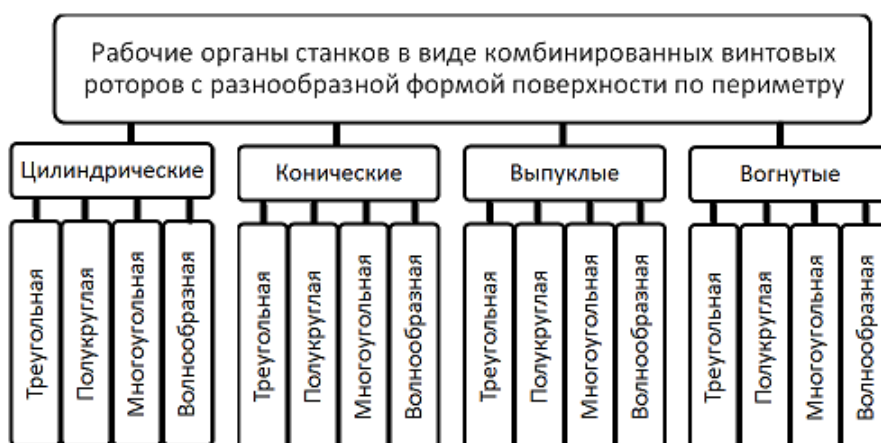
Рисунок 1. Классификация рабочих органов в виде комбинированных винтовых роторов с разнообразной формой поверхности по периметру
