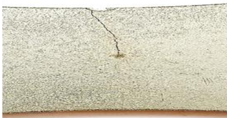
Рисунок 2. Усталостная трещина на поверхности образца из стали 20кп при \sigma = 235 МПа; N = 174000 циклов
