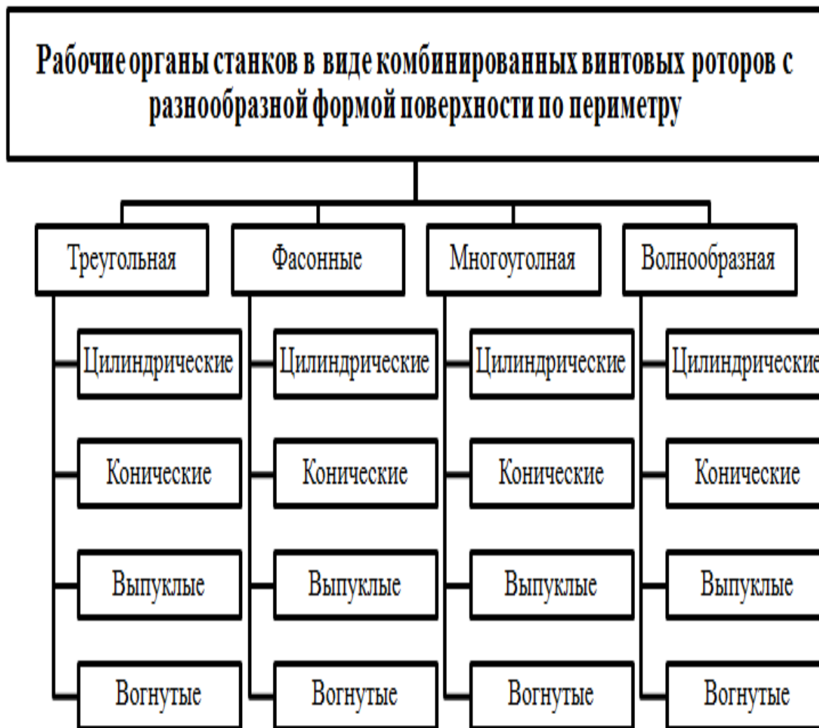
Рисунок 1. Классификация рабочих органов в виде комбинированных винтовых роторов с разнообразной формой поверхности по периметру
