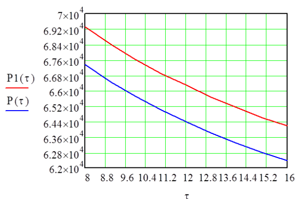
Рисунок 5. График зависимости износостойкости от ширины импульса
