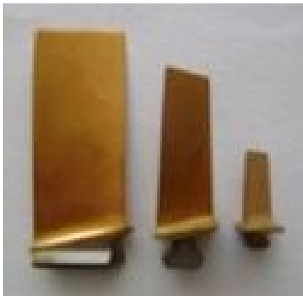
Рисунок 1. Общий вид лопаток компрессора с нитрид титановым покрытием
