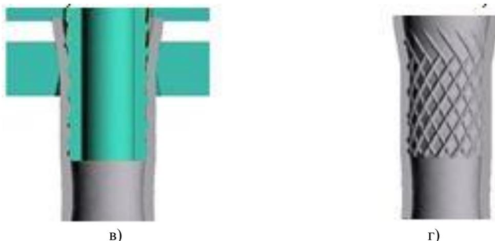
Рисунок 7. Компьютерное моделирование технологического процесса 2-й операции редуцирования трубной заготовки в программном комплексе QForm VX:
