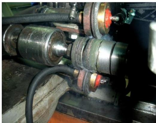
Рисунок 3. Процесс имплантирования карбида вольфрама
