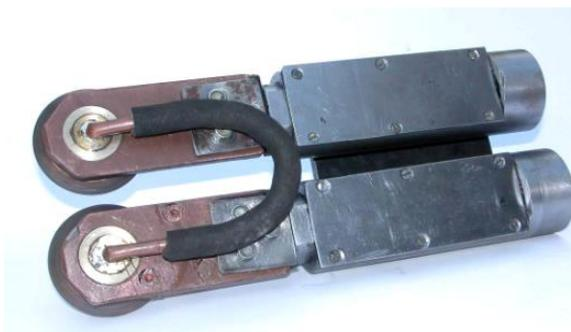
Рисунок 2. Инструментальная оснастка для электромеханической обработки
