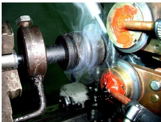
Рисунок 4. Упрочнение при ЭМО
