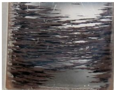
Рисунок 1. Упругие «струны» из ферритового порошка
