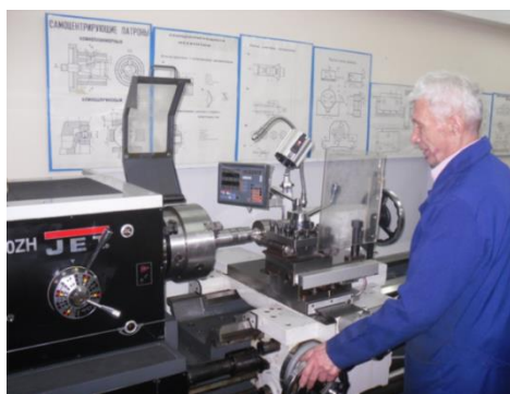
Рисунок 1. Экспериментальный стенд на базе токарно-винторезного станка GH2060ZH
