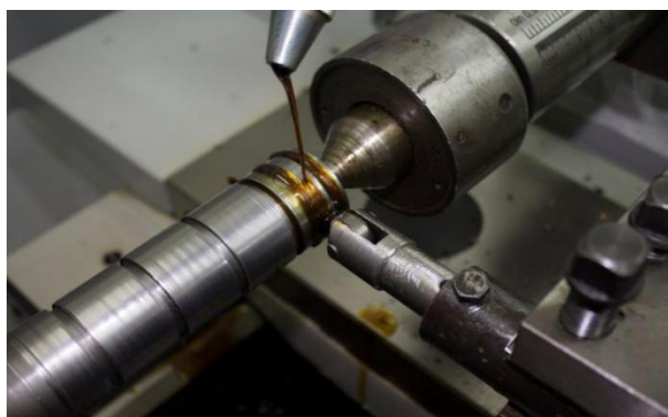
Рисунок 7. Процесс накатки роликовым накатником
