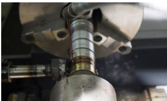
Рисунок 6. Процесс накатки шариковым накатником
