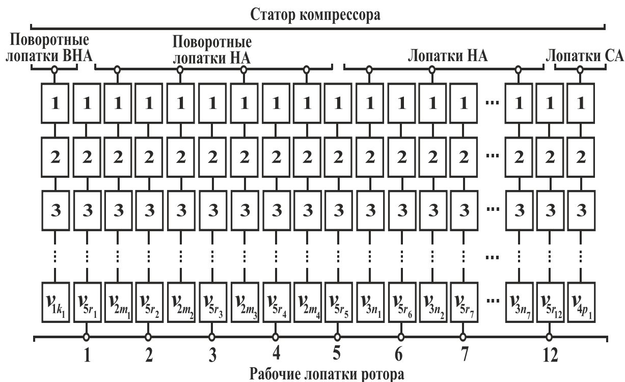
Рисунок 2. Гипотетическая схема структуры лопаток компрессора ГТД модели ТВ3-117
