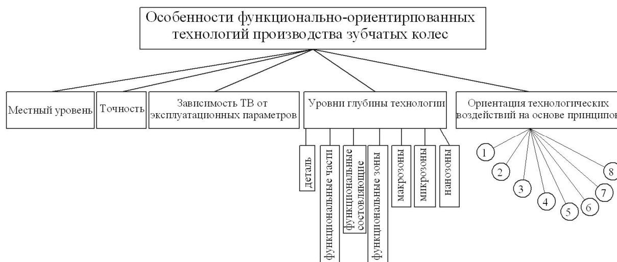
Рис. 3. Основные особенности функционально-ориентированных технологических процессов
