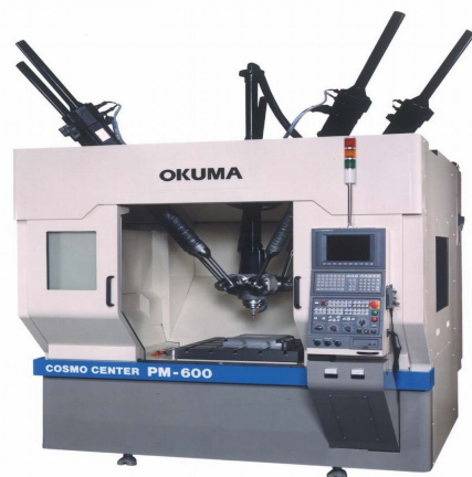
Рис.4 Верстат-гексапод мод. COSMOCENTER фірми Okuma (Японія)
