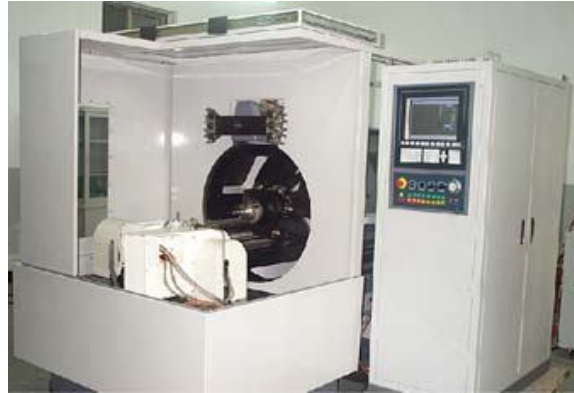
Рис.6 Трикоординатний фрезерно-свердлувальний верстат на основі механізму паралельної структури "триглайд" (Китай)
