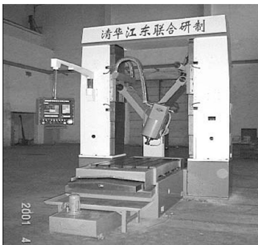
Рис.3 Фрезерно-свердлувальний верстат на основі механізму паралельної
