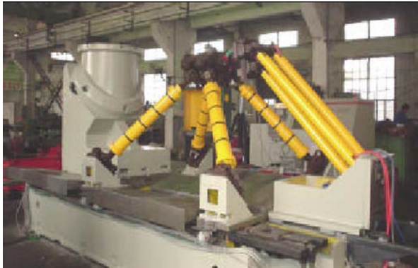
Рис.5 Чотирикоординатний верстат з ЧПК паралельної структури (Китай)
