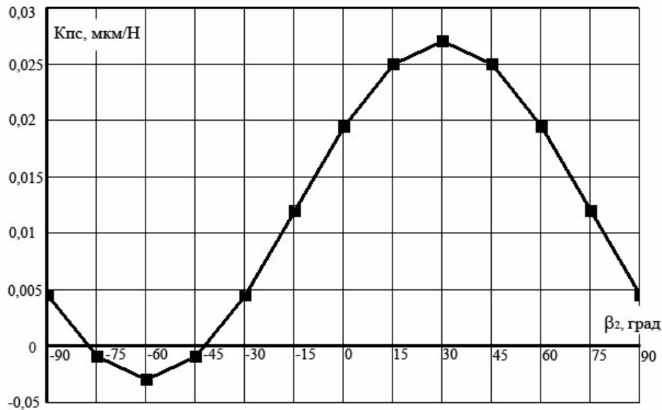
Рис. 3 Графік розрахункових значень статичної характеристики пружної системи різець-супорт K_{ПС} в залежності від зміни напрямку головних осей жорсткості підсистеми різцетримача \beta_2
