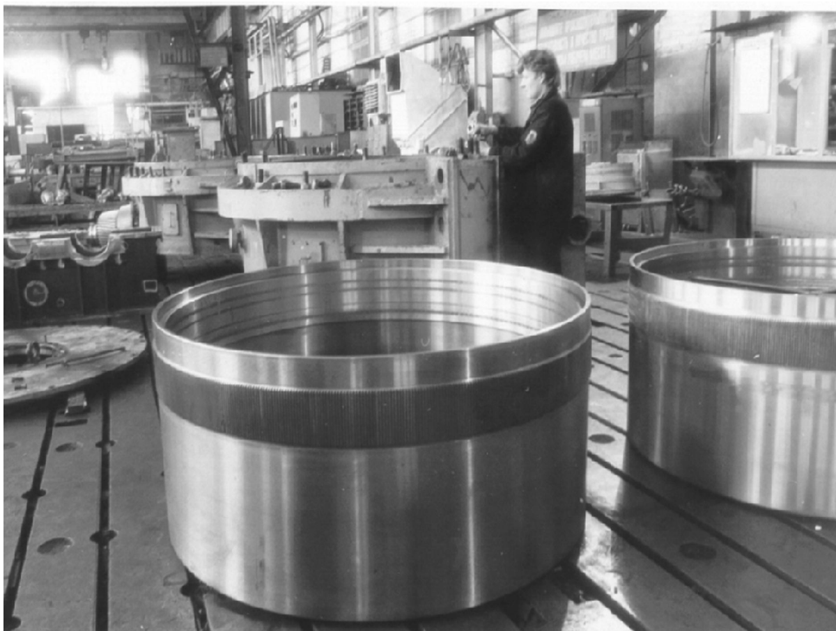
Рис. 4. Производство крупных волновых зубчатых редукторов на ЗАО «НКМЗ»
