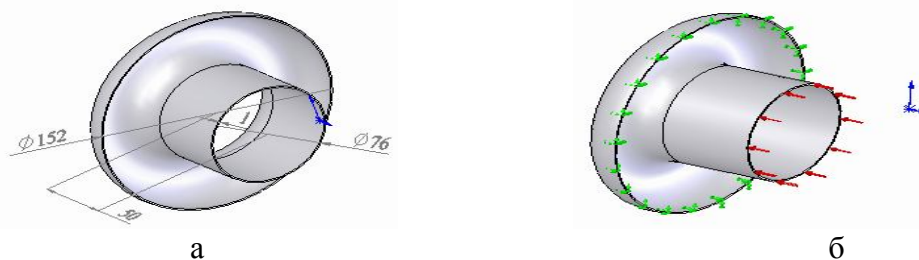
а- заготовка с основными размерами; б- схема нагружения заготовки
