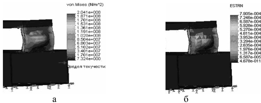
а- эквивалентные напряжения по Мизесу б- эквивалентные деформации
