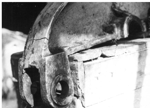
Рис. 2. Поломка двуплечего рычага давления верхнего рабочего валка ВОПМ-1800-К
