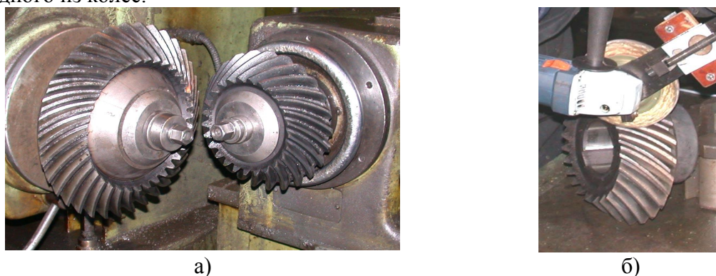
Рис. 1. Размещение конической пары на шумообкатном станке (а) и процесс нанесения покрытия на зубья шестерни (б)
