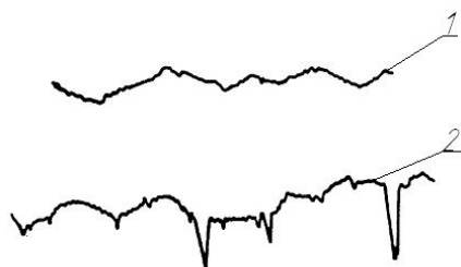
Рис.1. Профилограмма поверхности образцов из стали 9ХС (HRC 38...37) обработанных точением: 1 – вода с добавкой латекса ПВХ; 2 – вода. (Режим резания: t = 3 мм, S = 0,1 мм/об, V = 1 м/с; резец оснащен твердосплавной пластиной Т15К6)
