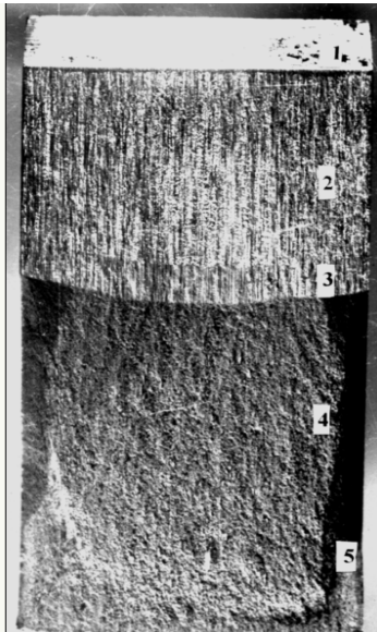
Рис. 4. Поверхня руйнування зразка товщиною 30 мм з попередньо наведеною тріщиною з сплаву Ti-6Al-1,5V-6Zr: 1 – зона механічного надрізу; 2 – зона втомної попередньо створеної тріщини; 3 – зона формування корозійної тріщини; 4 – зона корозійної тріщини; 5 – зона пластичного утягування металу при доламуванні зразка
