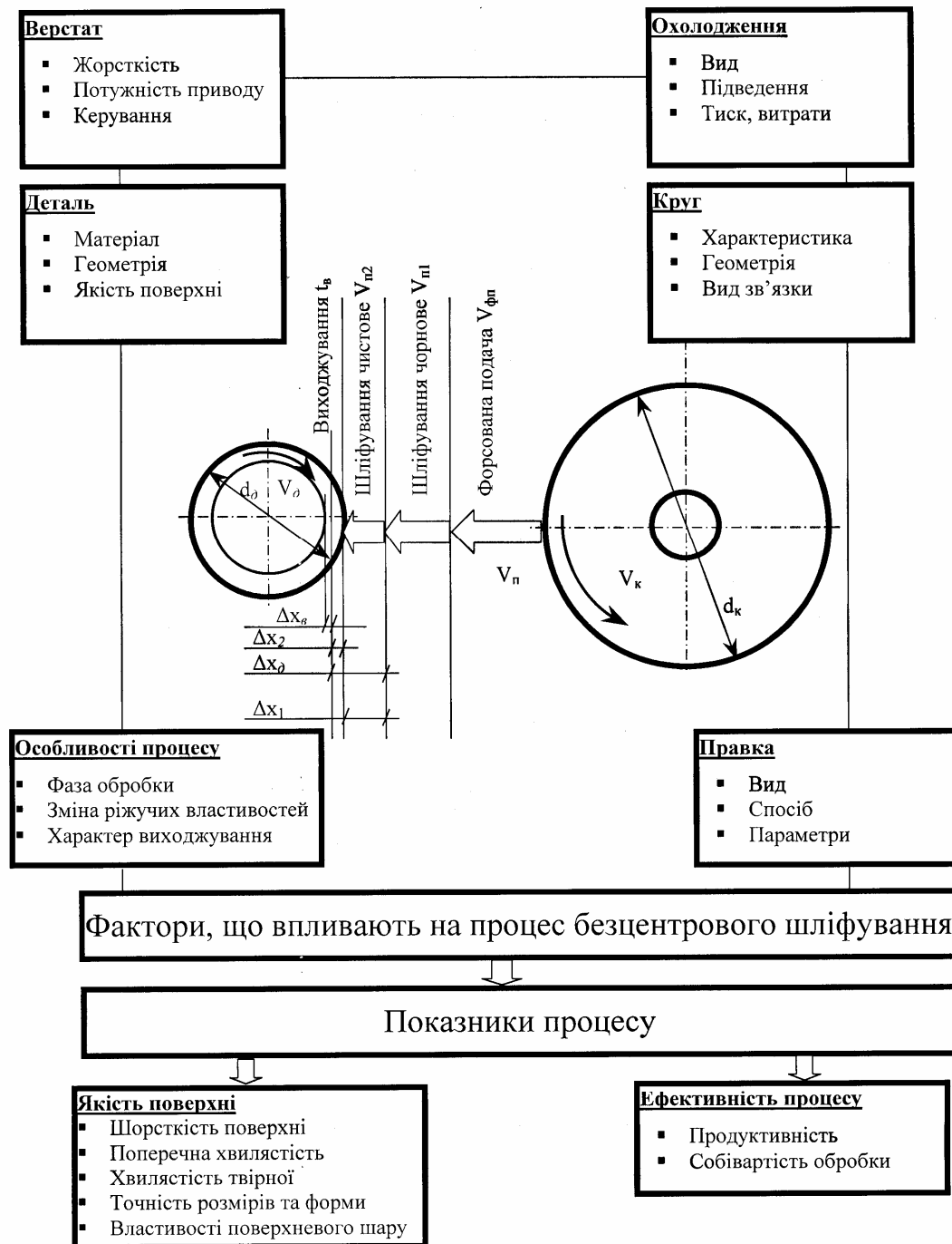
Рис. 1. Фактори впливу, параметри та показники процесу безцентрового візного шліфування доріжок кочення кілець роликопідшипників
