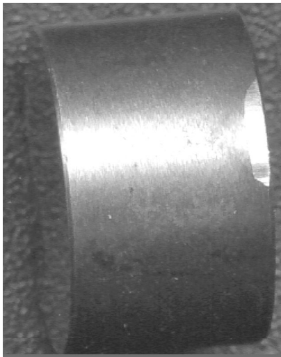
Рис. 6. Круглая режущая пласти с износом по задней поверхности
