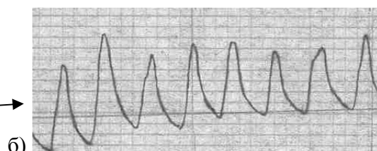
Рис. 2. Профилограммы поверхностей профиля прокатного валка: а – вогнутых и б - выпуклых участков
