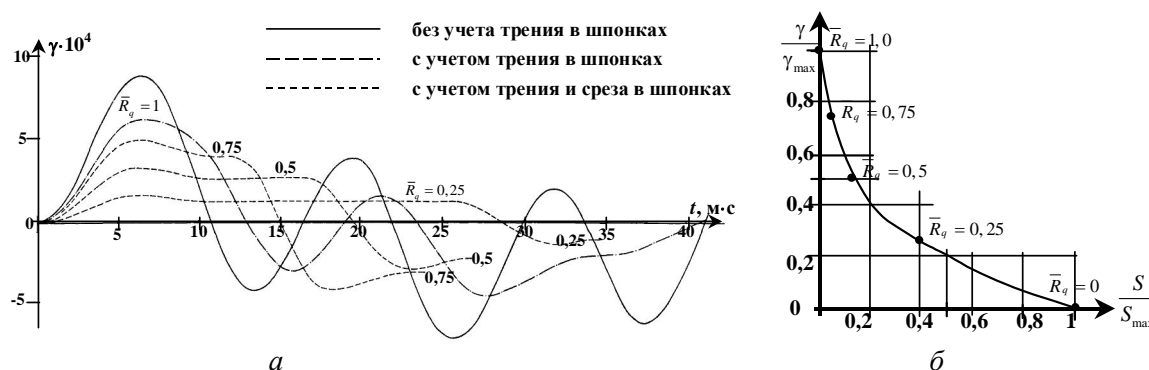
Рис.4. Влияние среза шпонок и трения в шпоночном узле на динамические характеристики (а) угловых перемещений агрегата ППУ и относительные амплитуды колебаний (б)
