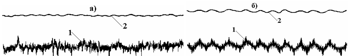
Рис. 6. Осциллограмма крутящих моментов на валах волнового редуктора привода поворота передвижного миксера МП-600АС, при частоте вращения входного вала \omega_1 = 1,667 \text{ с}^{-1} : 1-
