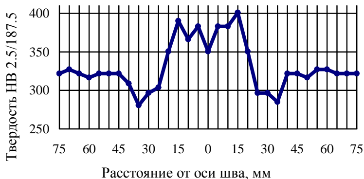
Рис. 3. Распределение микротвердости в поперечном сечении свариваемого термитной сваркой стыка рельс (в области шейки рельса)
