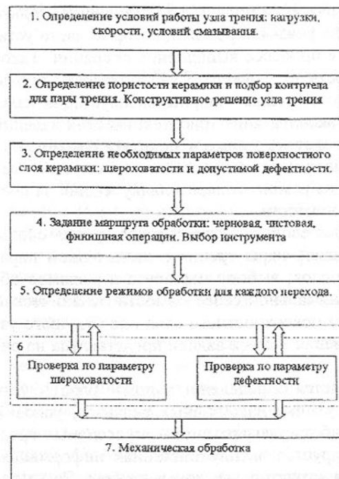
Рис. 1. Структурная схема выбора пары трения на основе керамики и определения параметров механической обработки
